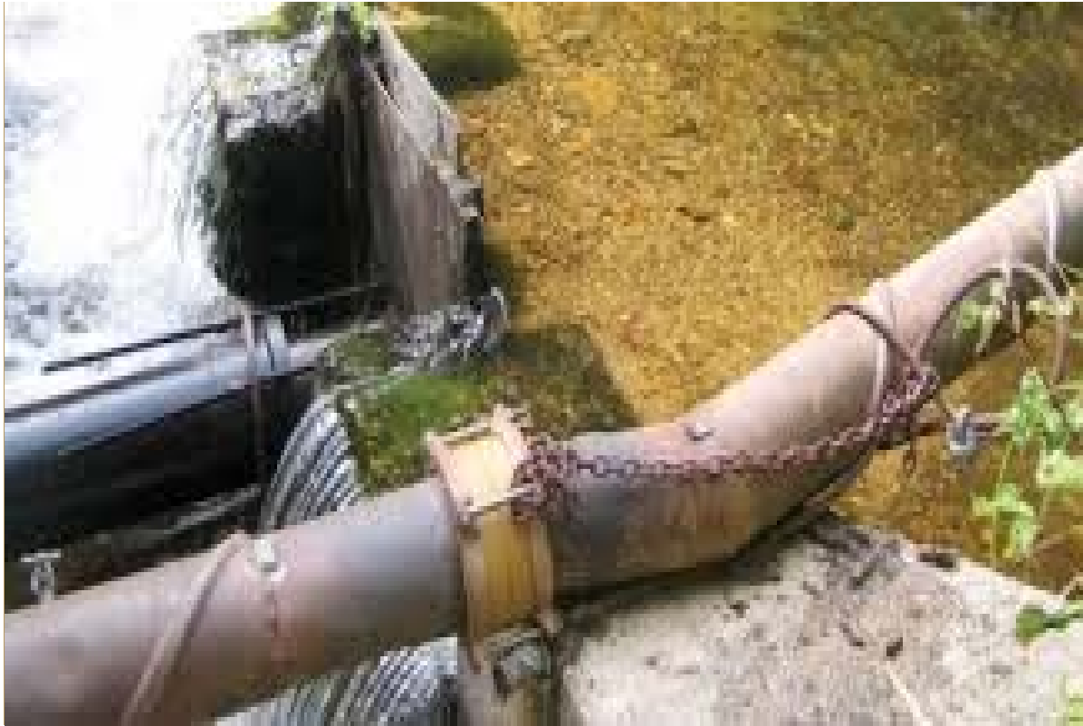
Slika 4. Lokalno izvijanje najverovatnije usled koncentracije opterećenja [27]
