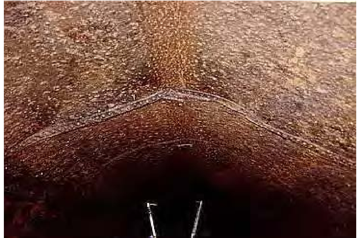
Slika 4. Lokalno izvijanje najverovatnije usled koncentracije opterećenja [27]
