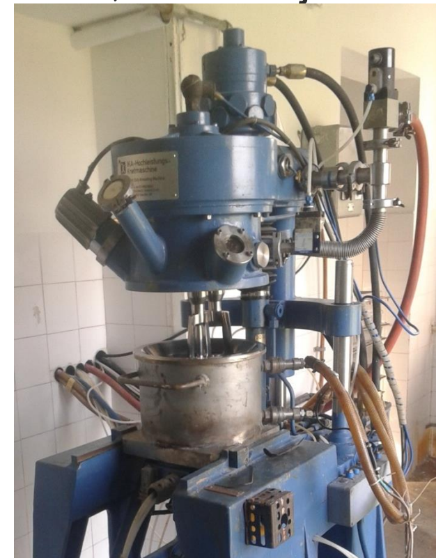
Vertikalni mešač radne zapremine 4.5 kg
