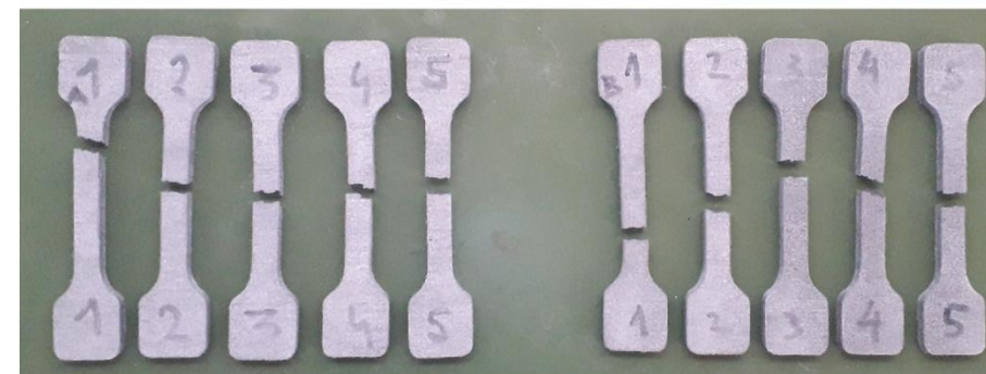
Uzorci PBX eksploziva za određivanje mehaničkih karakteristika
